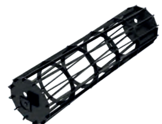
Планчастий барабан планки розташовані під кутом
