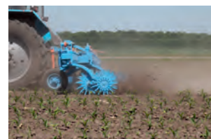
Борона ротатійна ANTOKS під час роботи
